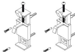
Pour la fixation de l'appareil au mur, utilisez le gabarit fourni dans le carton. Veuillez suivre les indications ci-dessous:
