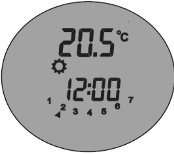
EXEMPLO EM MODO "CONFORT"
