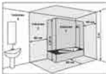
Volume 1: Aparelhos da Muito Baixa Tensão de Segurança (MBTS). Volume 2: Aparelhos elétricos Classe II – IP X4 Volume 3: Aparelhos elétricos protegidos por meio de um dispositivo diferencial de corrente diferencial estipulada I_{\Delta n} , não superior a 30 mA.
